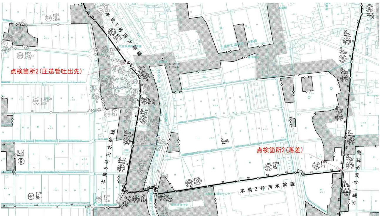
図5-1 管きよ点検箇所の例（本巢処理区）
