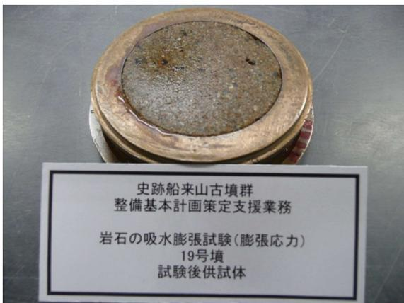
19号墳試験後供試体
