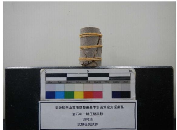
58号墳試験後供試体
