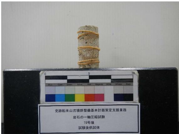
19号墳試験後供試体
