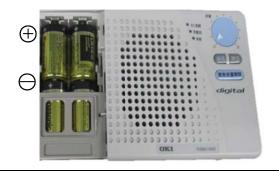
②受信機を机などの上に置き、図のように電池 ぶたを下に押し付けながら→の方向に押す。
