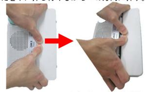
※電池ぶたが外しづらいときは、手のひらで強く押し つけて→の方向に押す。
