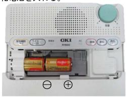
②受信機を机などの上に置き、図のように電池 ぶたを下に押し付けながら→の方向に押す。
