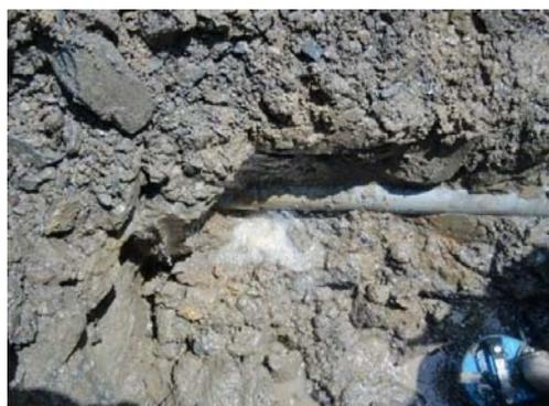
塩化ビニル管（TS継手部）の漏水（口径100mm）
